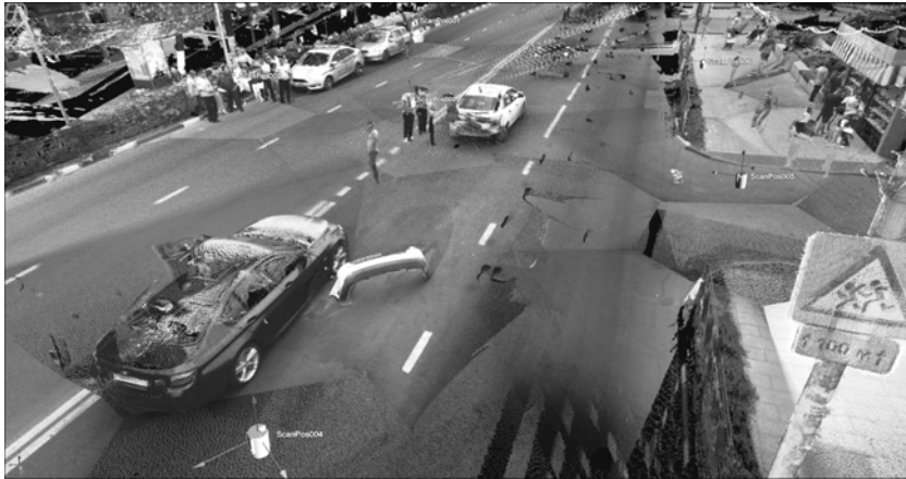
Рис. 1. Сканирование места ДТП с одновременным фотографированием
